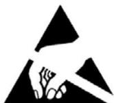
Produkten innehåller elektronik som kan vara känslig för såväl elektrostatisk urladdning (ESD) som mekanisk påkänning. Direkt beröring (via hand eller verktyg) av åtkomliga kretskort typ LED-moduler skall undvikas. Gäller såväl vid installation som underhåll.
